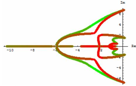
Fig. 10. CDM-PI pole spread ( $T=2$ ,  $L=0.5$ ,  $a=0.25$ )
