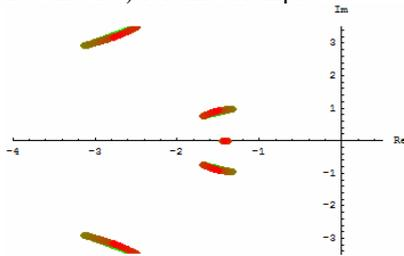
Fig. 8. CDM-PI pole spread ( $T=2$ ,  $L=0.5$ ,  $a=1$ )
