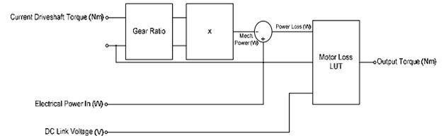
Figure 4: Model for the actual output torque
